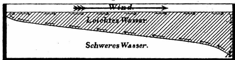
Vom Winde hervorgerufene Zirkulation in geschichtetem Wasser.
